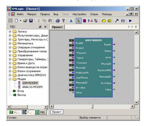
Для подключения модема в проект достаточно установить соответствующий FBD-блок на поляну SMLogix и в диалоговом окне произвести необходимые настройки модема.
