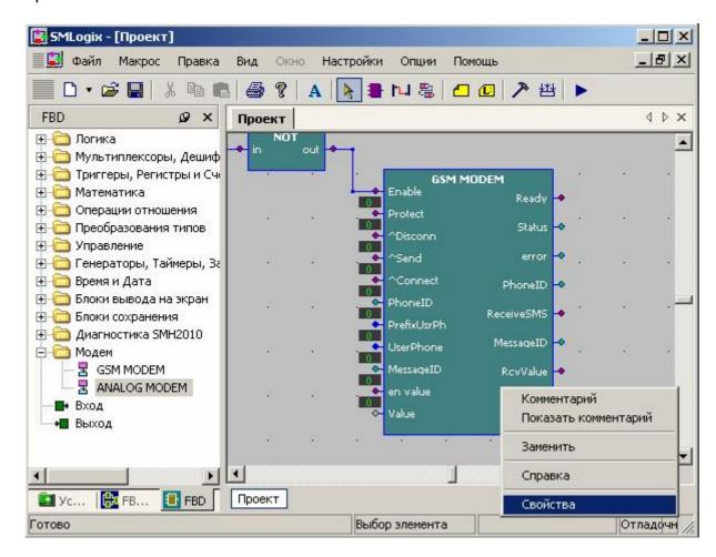
В общих настройках задаются тип модема, номера телефонов дозвона, *PIN-код* Вашей SIM-карты, номер сервис-центра SMS и *пароль* доступа к проекту при дозвоне. Для обеспечения установления связи при использовании пароля, пароли проектов "master" и "slave" должны совпадать.
