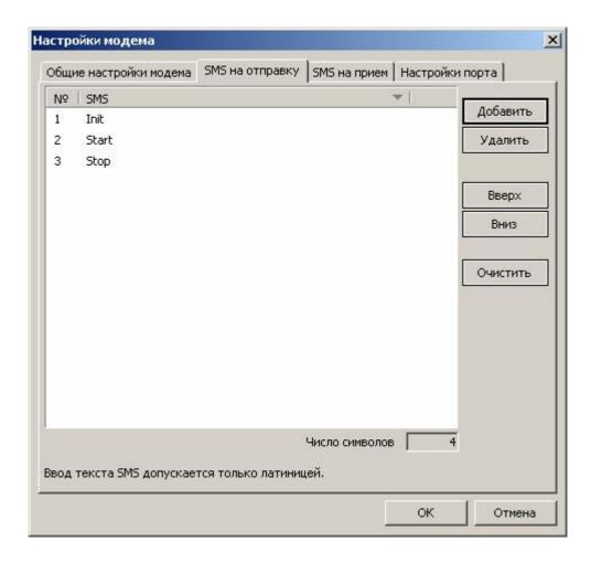
Выбор требуемой для отправки команды или сообщения осуществляется с помощью выбора порядкового номера SMS в базе путем задания соответствующего значения на входе « MessageID» FBD-блока «GSM MODEM».
