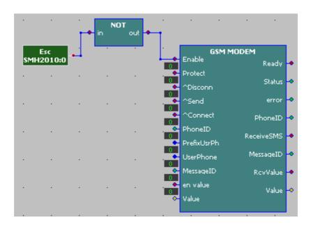
При конфигурировании запросов на порт модема все переменные "slave" в проекте становятся доступными только через модем в момент установления связи. Присоединение переменных "slave" осуществляется стандартным образом с использованием карты памяти устройства.
