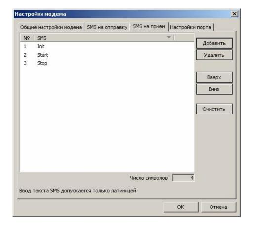
После приема SMS происходит ее обработка блоком GSM MODEM. Принятое сообщение первоначально проверяется на соответствие номера отправителя разрешенным номерам в базе. Если пришло сообщение с разрешенного номера, на выходе "PhoneID" отображается его порядковый номер в базе, в противном случае отображается значение "-1" - номер в базе не обнаружен.
