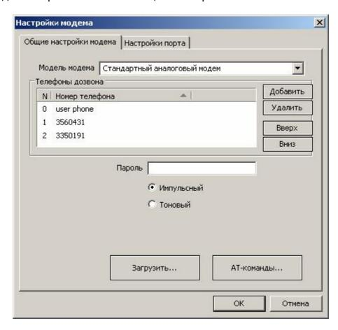
В общих настройках задаются тип модема, номера телефонов дозвона, тип набора номера – импульсный или тоновый, и пароль для установления связи для
