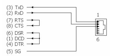
В этой схеме модем при включении своего питания переходит в режим приёма данных, принимает команду от контроллера и далее нормально "общается" с контроллером в обоих направлениях. Слева от названий сигналов подписаны контакты стандартного разъёма DB9. Разъём контроллера – вид сверху на плату.
