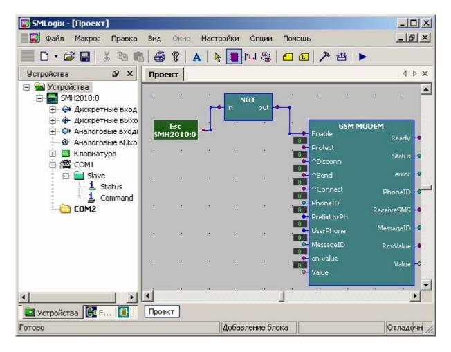
При конфигурировании переменных "slave" следует помнить, что настройки СОМ-порта и рабочие таймауты должны соответствовать параметрам сети, а именно удовлетворять настройкам и параметрам применяемых модемов. Поддерживаемые скорость и настройки СОМ-порта зависят от типов модемов и различны у различных производителей.
