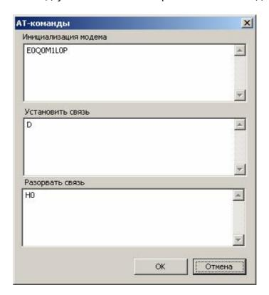
Для задания индивидуальных параметров набора каждого из номеров их можно прописать непосредственно в поле номеров для дозвона в виде требуемых АТ - команд. Например, если для большинства номеров тип набора импульсный, а один из номеров нужно набирать в тоне, то в поле «Телефоны дозвона» для него можно записать DT3350191. В этом случае набор для него будет осуществлен индивидуально в тоновом режиме. Аналогично, можно задать другие индивидуальные параметры набора.
