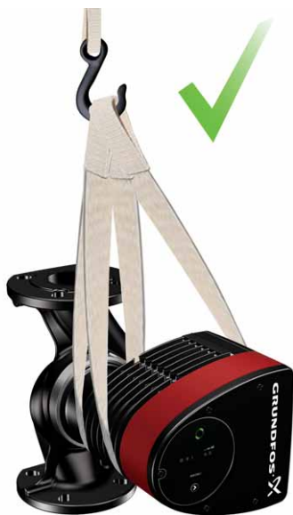
Рис. 9 Правильный способ строповки насоса
