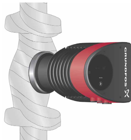
Рис. 17 Изоляция корпуса насоса и трубопровода
